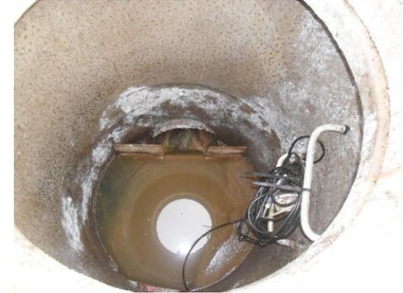
Mesure de débit sur collecteur EU gravitaire avec sonde piezo et déversoir en V
